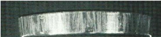
Si el diámetro no es redondo o si el diámetro exterior es muy grande para el alojamiento, la caja se puede deformar durante la instalación o se utilizaron herramientas de instalación inadecuadas al colocar el retén a presión.
