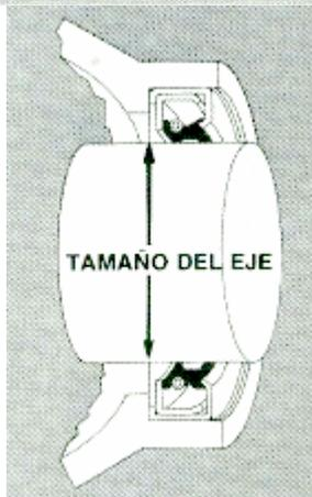
Cuando se seleccione un retén por medio de las dimensiones, puede ser más fácil y exacto medir primero el diámetro o el tamaño del eje y luego consultar el manual de especificaciones del fabricante.
