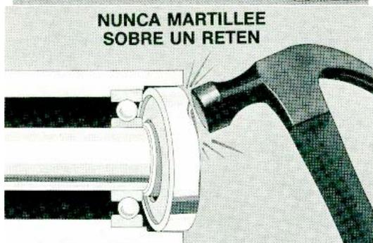
Nunca martillee directamente sobre un retén. Si no tiene las herramientas apropiadas, una alternativa aceptable es utilizar una pista de rodamiento como adaptador, colocado contra la caja del retén. Después utilice un mazo de plástico para introducir el retén dentro del alojamiento.
