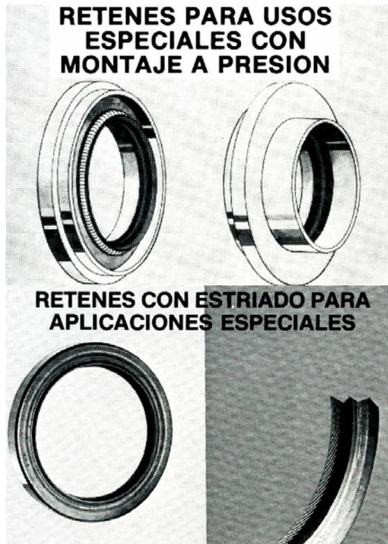
El diseño de los retenes para aplicaciones especiales se diferencia de aquel de los retenes para aplicaciones generales, en que las cajas pueden tener varios escalones, contornos externos, pestañas o una construcción interna especial. Normalmente se instalan a presión dentro de un alojamiento
